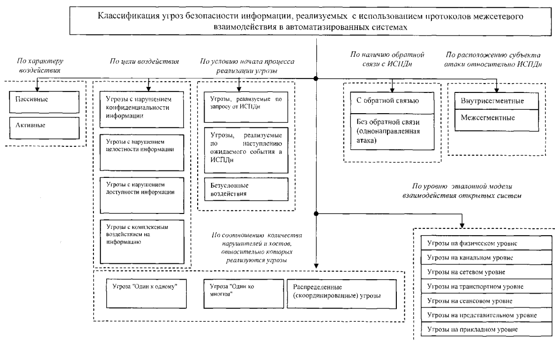
нок 5. Классификационная схема угроз с использованием протоколов межсетевого взаимодействия"
