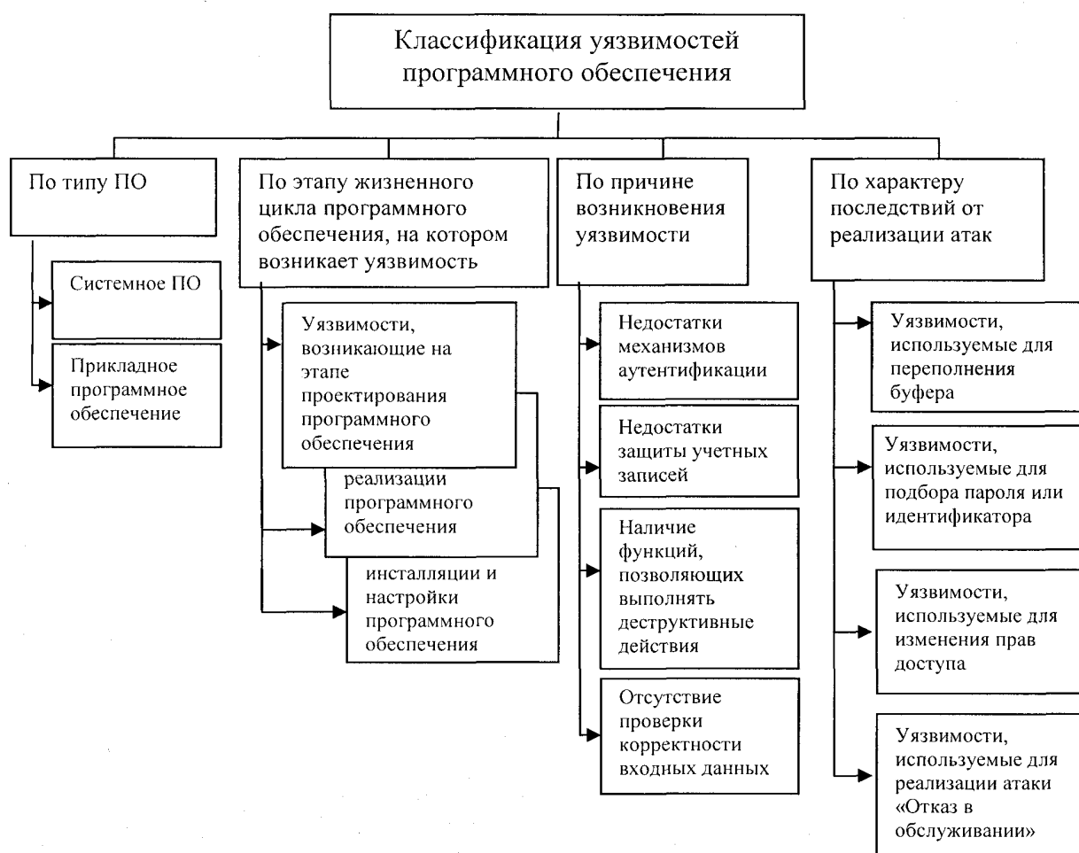
"Рисунок 4. Классификация уязвимостей программного обеспечения"
