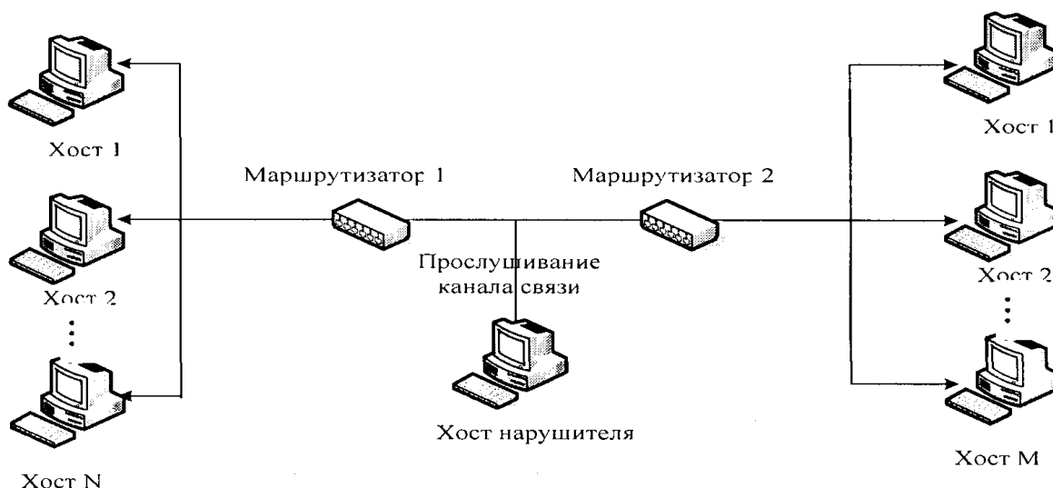
"Рисунок 6. Схема реализации угрозы "Анализ сетевого трафика"
